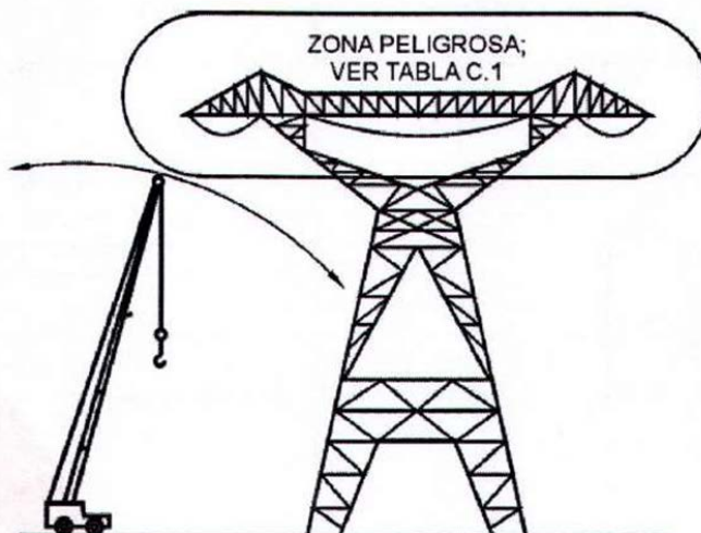
Figura F.2 – Zona peligrosa para grúas y cargas izadas, que operen en proximidad de líneas de transmisión eléctricas
